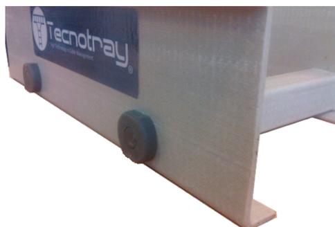
El ensamble se efectúa por medio de un remache plástico que tiene su expansión en el interior del travesañó, fortaleciendo así la unión del travesañó con el lateral este proceso se realiza en ambos extremos
