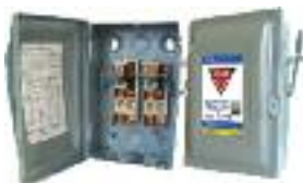
WD2226 - Gris 1 Fase 2 Hilos o 2 Fases 3 Hilos 120/240 V~; 50-60 Hz. Gabinete tipo NEMA 1 (usos generales). Base bipartida de cerámica
