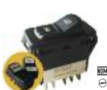
NGR New Generation Rockers 15 A, 125V~ 10 A, 250 V~ 15 A, 14-28 V/CD Variedad de botones intercambiables Iluminación LED o incandescente Índice de protección IP42 Configuraciones de 1P1T, 2P1T, 1P2T, 2P2T
