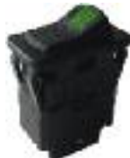
SVR Sealed Vehicle Rockers 12 A, 12-24 V/CD Iluminación LED Índice de protección IP68 Configuraciones de 1P1T, 2P1T, 1P2T, 2P2T
