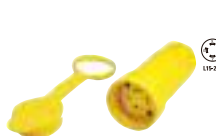
L1520CW Receptáculo media vuelta 3P 4H 20A 250V~ NEMA L15-20R
