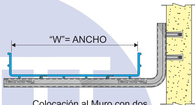
Colocación al Muro con dos tornillos de 3/8".
