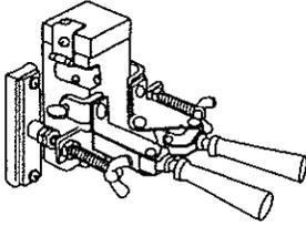
El molde CADWELD puede sujetarse firmemente a una gran superficie vertical ligeramente curva o completamente plana, utilizando la manija con soporte magnético. Para usarse en moldes de apertura vertical.
