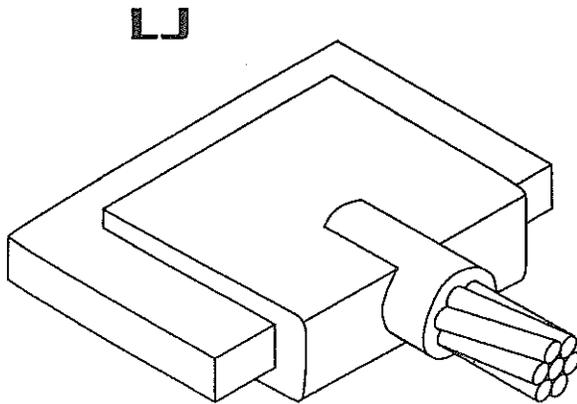
**CONEXION DE CABLE HORIZONTAL
