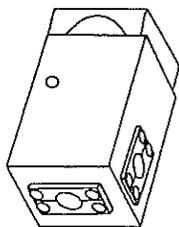
Las placas de refuerzo reducen el desgaste mecánico de los moldes en los orificios de entrada de los cables y ayudan a prevenir la filtración de la carga fundida (particularmente en conductores de 7 hilos de calibres grandes). Estas características prolongan la vida útil del molde.
