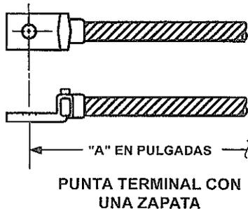
\* "A" INDICA LA LONGITUD DEL PUENTE EN PULGADAS
