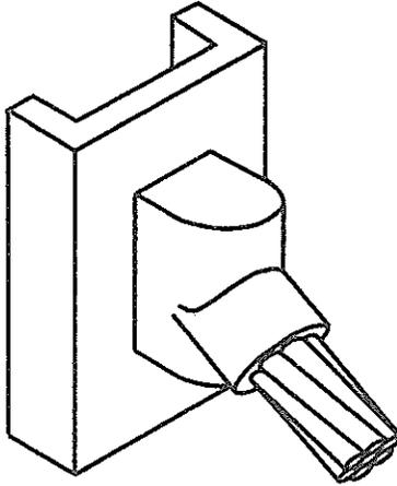
**CONEXION DE CABLE A 45° A SUPERFICIE DE ACERO VERTICAL**
