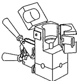
Los moldes de apertura horizontal y la sección del crisol sólida pueden especificarse como un TIPO de CRISOL DIVIDIDO. La ventaja del MOLDE CON CRISOL DIVIDIDO es la de su fácil limpieza, pero el tiempo que le lleva es más largo.
