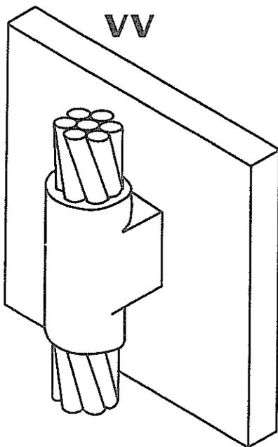
**CONEXION DE CABLE VERTICAL A SUPERFICIE DE ACERO VERTICAL**
