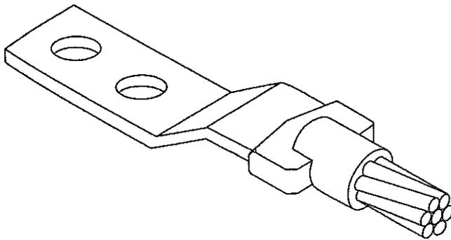
CONEXION DE CABLE A ZAPATA O BUS DE COBRE
