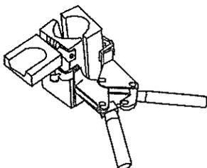
Un molde de grafito semipermanente es usado para hacer las conexiones CADWELD. El molde controla la dirección y velocidad del fluido de la carga fundida CADWELD y su forma final. El grafito usado en un molde CADWELD es resistente a altas temperaturas y rinde un promedio de 50 ó más conexiones CADWELD en condiciones de uso normal.
