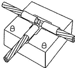
Los casquillos CADWELD son usados para adaptar un rango limitado de cables de calibres menores a moldes CADWELD para calibres mayores.
