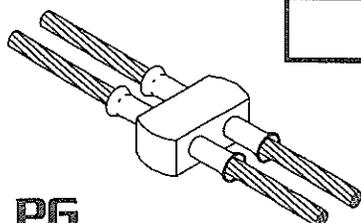
El molde desechable CADWELD tipo ONE SHOT® es de cerámica, reemplazando al conocido semi-permanente molde de grafito y su correspondiente manija. Todo el material necesario para realizar la conexión está incluido, excepto el chispero.
