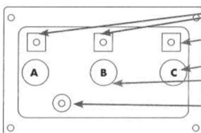
POSTE DE TIERRA PARA CONDUCTOR DE TIERRA DE CABLE FLEXIBLE.
