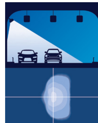
Ilumina el ingreso e interior del túnel, montaje lateral. Configuración típica central de 3 carriles
