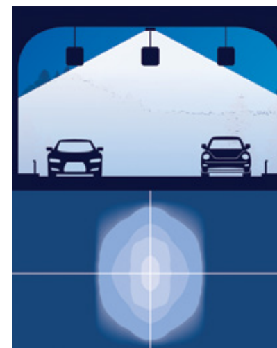
Ilumina el ingreso e interior del túnel. Configuración típica central de 3 carriles.
