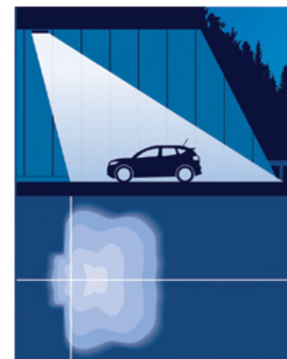
Ilumina el ingreso del túnel. Configuración típica de 2-3 carriles.
