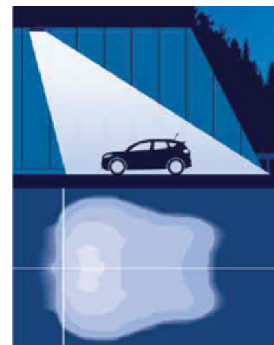
Ilumina el ingreso del túnel. Configuración típica central de 2 carriles
