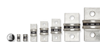
JJN. Clase T, 300 V, IR de 200 kA, hasta 1,200 A
