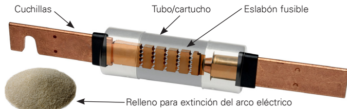
Figura 2. Fusible LPS-RK, Low-Peak, de doble elemento y retardo de tiempo, que muestra las cuatro características de construcción comunes.
