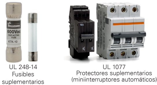
Figura 43. Los OCPD suplementarios no pueden usarse para protección de circuitos derivados.
