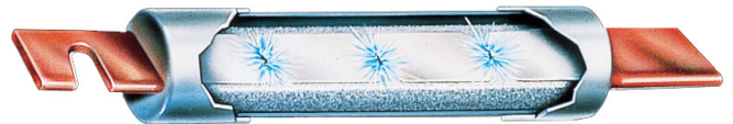
Figura 6. Cuando están sujetas a una corriente de falla, varias secciones del eslabón del fusible se funden casi instantáneamente.
