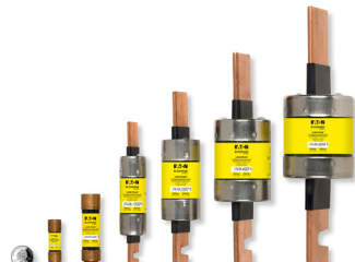
LPN-RK. Clase RK1, 250 V, IR de 300 kA, hasta 600 A
