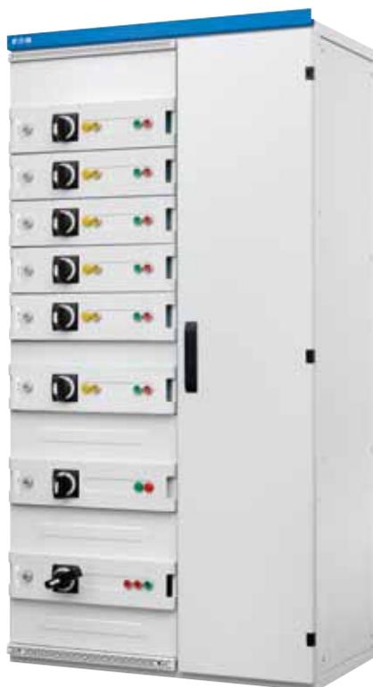
El mantenimiento y la sustitución de equipos son posibles en pocos segundos con los armarios XW de xEnergy. Gracias a esto, unidades individuales totalmente cableadas pueden ser reemplazadas con el resto del cuadro en funcionamiento, quedando éstas en suspensión y de una forma sencilla se puede actuar en estos cubículos para cualquier tipo de tarea necesaria.
