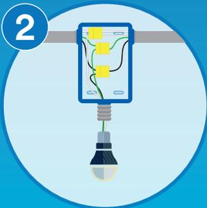
2 Cajas de conexión para luminarias con Conectores Derivadores Scotchlok® IDC 562.
