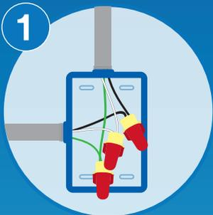
1 Cajas de conexión para luminarias con Conectores de Resorte R/Y.
