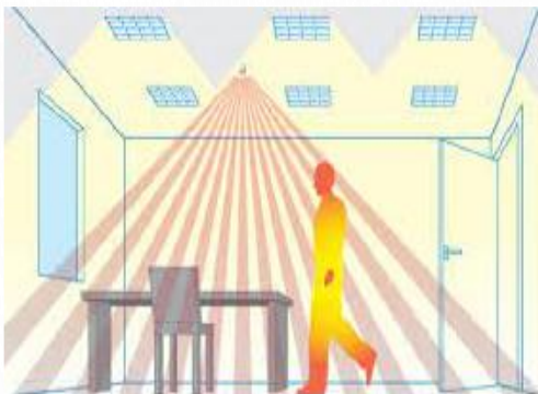
PIR Detección por infrarrojo pasivo
