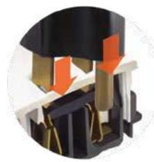
Sistema de seguridad patentado en todas sus tomas de corriente. Cuando se introduce algún objeto en una sola ranura de fase, el sistema interno bloquea la entrada.
