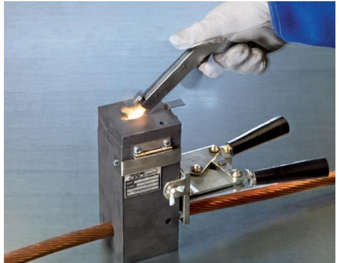
El **Procedimiento de Encendido LsVIP KLK** utiliza una tapa especial que cierra completamente el crisol del molde, evitando salpicaduras durante la reacción aluminotérmica. Al mismo tiempo, permite la liberación de sobre presiones dentro del crisol. Además, las emisiones de humo son considerablemente más bajas que en otros procedimientos de encendido.
