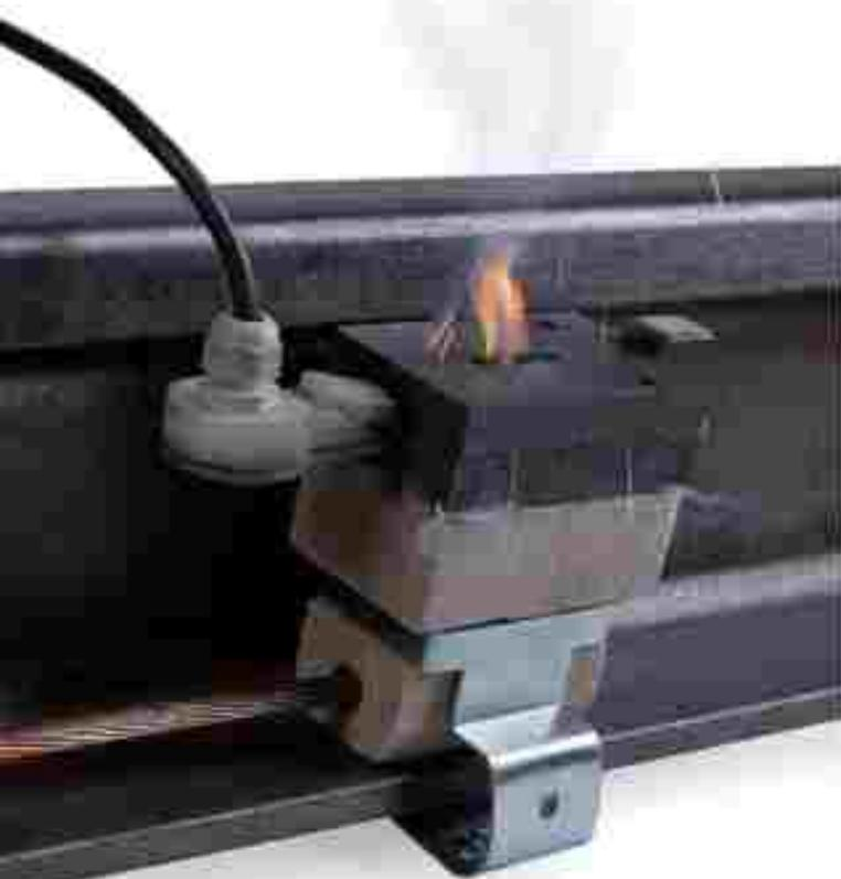
La resistencia eléctrica de la conexión es menor que  $10^{-6} \Omega$ , y la resistencia mecánica a la cizalladura en la unión placa/carril es mayor que 50 kN.
