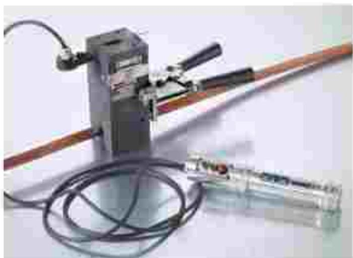
El Procedimiento de encendido LsVIP hace uso de una tapa especial que cierra completamente la tolva-crisol del molde, de manera que evita la salida al exterior de las proyecciones procedentes de la reacción aluminotérmica pero al mismo tiempo permite la liberación de sobrepresiones en el interior del crisol. Además la cantidad de humo producido es menor que en otros procedimientos de encendido.
