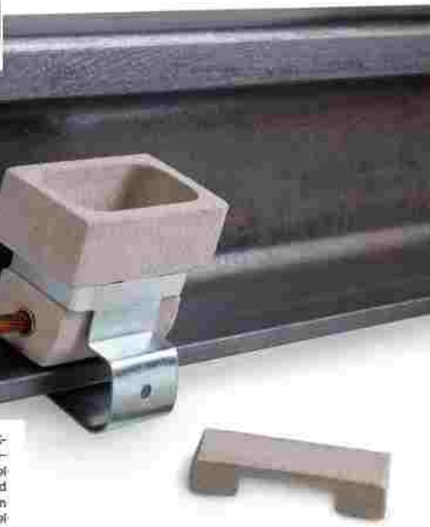
El procedimiento de soldadura **ELPA KLK-weld** es la mejor solución para realizar conexión eléctrica de cable de cobre al patín del carril, pues se consigue una baja resistividad eléctrica y una alta resistencia mecánica en la conexión, todo ello sin afectar al acero del carril, pues la temperatura en el mismo nunca supera los 600°C.
