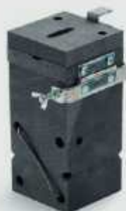
Molde. Los moldes se mecanizan a partir de un bloque de material refractario (grafito).
